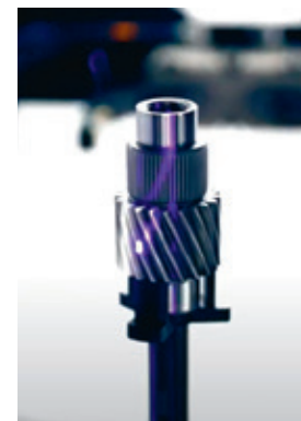
Mät- och inspektionsutrustningen ZeroTouch® använder avancerad laserteknik.
