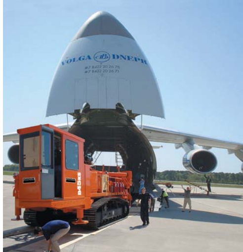
Lastning av en Sandvik D45KS, en rigg för ovanjordsborrning, på ett ryskt fraktflygplan av typen Antonov för transport till guldgruvan Kumtor i Kirgizistan.
