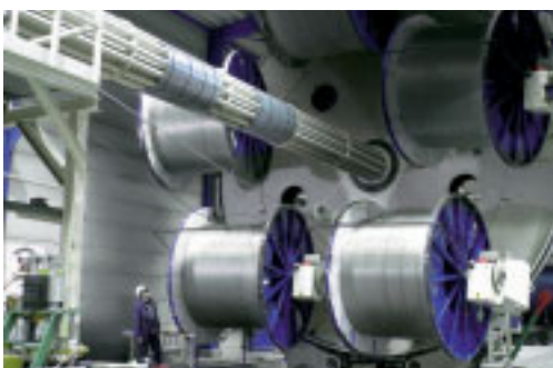
Sandviks sömlösa rostfria rör på spole spelar en viktig roll vid framställning av umbilicals inom olja/gasindustrin.
