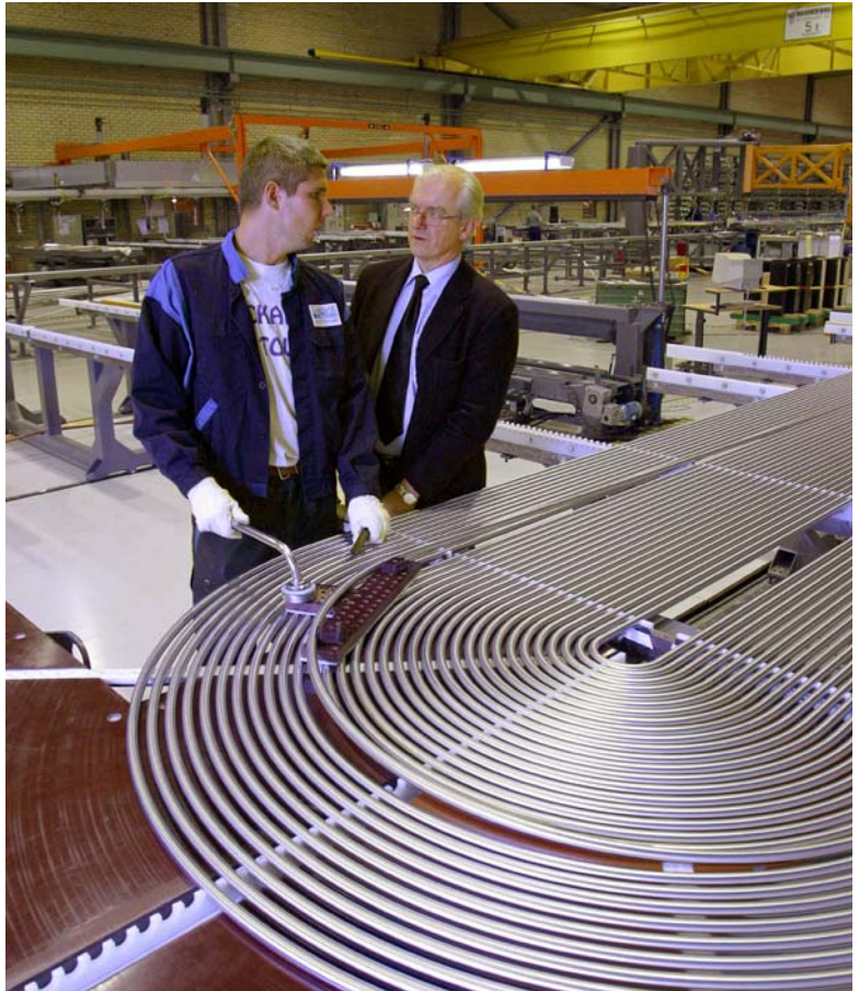
Peter Gossas, chef för Sandvik Materials Technology, på ett av många besök i produktionen. Här färdigställs ånggeneratorrör i Rörverk 68.
